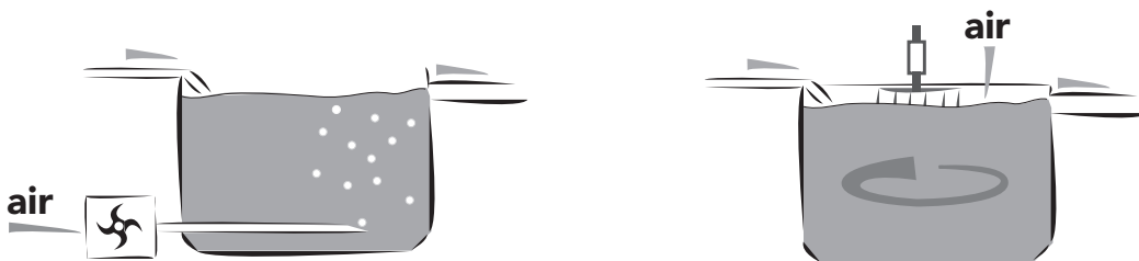
Insufflation d'air par ventilateur ou compresseur
